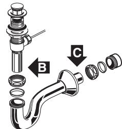
Raccorder les conduits d'alimentation d'eau chaude et d'eau froide aux robinets de sectionnement. Resserer les joints du siphon pour rendre l'assemblage étanche.
