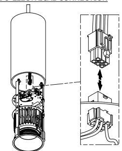
WHILE SUPPORTING REFLECTOR ASSEMBLY, UNDO ELECTRICAL CONNECTION AS SHOWN
