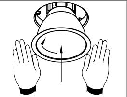
5.) USE GLOVES TO PREVENT FINGERPRINTS. INSTALL TRIM BY PUSHING STRAIGHT UP ON THE REFLECTOR FLANGE. ROTATE CLOCKWISE TO DRAW REFLECTOR FLANGLE TIGHT AGAINST THE FINISHED CEILING. REFER TO RELAMP LABEL AND INSTALL PROPER LAMP/S. TO REMOVE THE REFLECTOR, ROTATE THE FLANGE COUNTERCLOCKWISE AND PULL DOWN.
