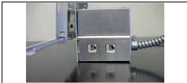
Figura 11. Enchufes RJ45 de entrada/salida del regulador
