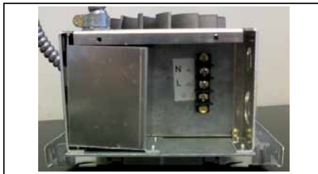
Figure 5. Couvercle de la boîte de jonction
