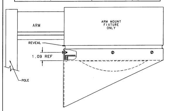
LOCATE SHIELD ON HOUSE SIDE OF FIXTURE PER FIGURE. THE EDGE OF THE SHIELD SHOULD REST JUST BELOW THE REVEAL. DRILL HOUSING USING SHIELD AS TEMPLATE. INSTALL NINE (9) #10 SCREWS AND NUTS TO SECURE SHIELD TO HOUSING.
