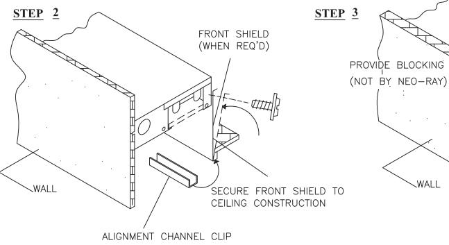
ATTACH VERTICAL FRONT SHIELD TO HOUSING AND ADJUST TO DESIRED HEIGHT.INSERT ALIGNMENT CHANNEL CLIPS FOR SERIES 71 AND 72.
