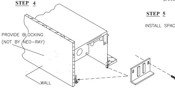
INSTALL SPACER BLADE AT EVERY ALIGNMENT CLIP.
