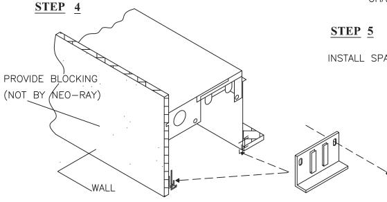
INSTALL SPACER BLADE AT EVERY ALIGNMENT CLIP.
