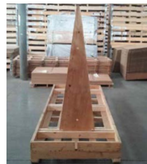
FIG. 2 A-FRAME = LAM-CRATE 124 X 44 / LAM-CRATE 144 X 33 = 40 PCS CAPACIDAD MÁXIMA PARA 3+ Y 20 PCS CAPACIDAD MÁXIMA PARA 5.6
