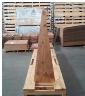
FIG. 2 A-FRAME = LAM-CRATE 124 X 44 / LAM-CRATE 144 X 33 = 40 PCS CAPACIDAD MÁXIMA PARA 3+ Y 20 PCS CAPACIDAD MÁXIMA PARA 5.6
