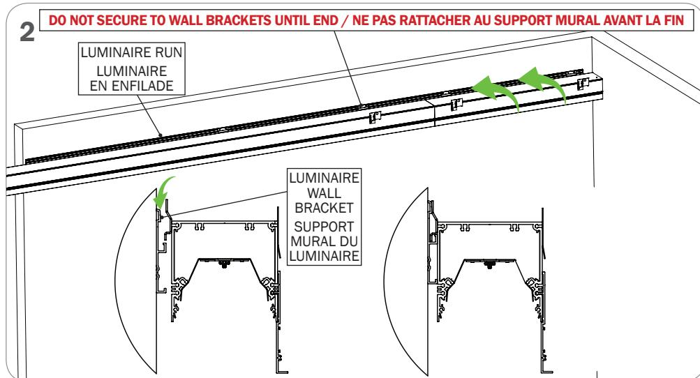
HANG LUMINAIRE ON WALL TRACK NEXT TO LUMINAIRE RUN
