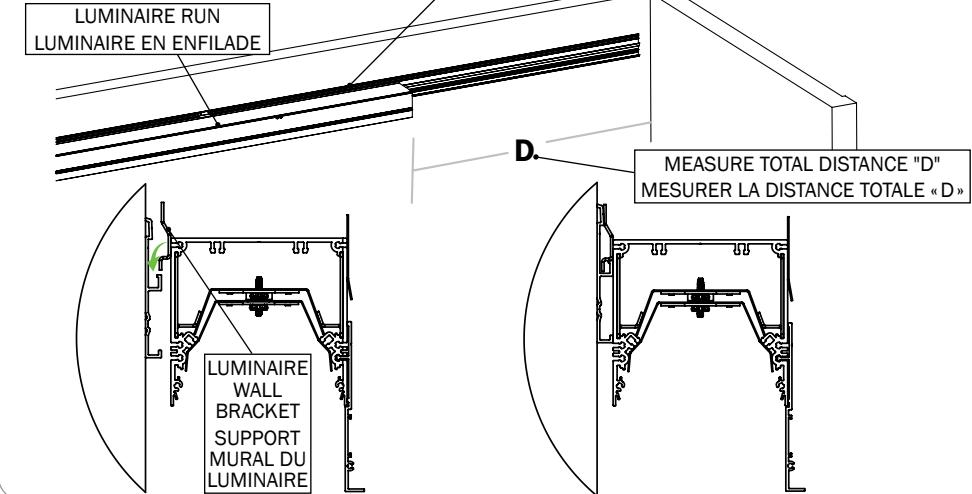
INSTALLER LES LUMINAIRES À PÉRIMÈTRE FIXE EN SUSPENDANT LE SUPPORT MURAL SUR LE RAIL DU LUMINAIRE
