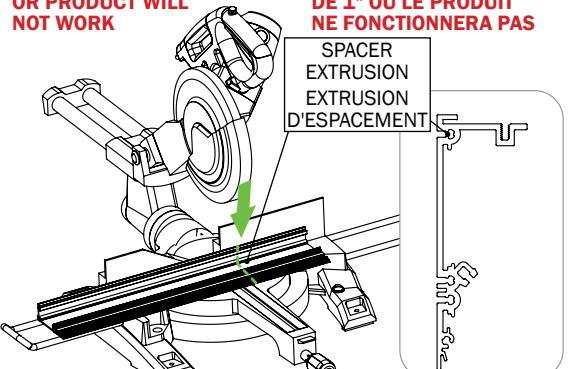
CUT SPACER EXTRUSION TO MAKE UP DIFFERENCE.
