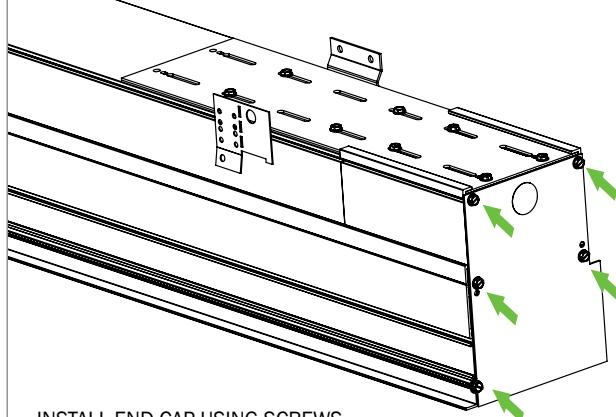
INSTALL END CAP USING SCREWS
