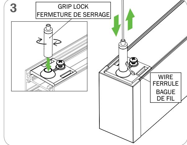
LEVEL THE FIXTURE STRAIGHT BY PRESSING ON THE GRIP LOCK
