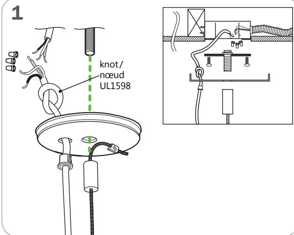
CONNECT THE POWER CORD TO THE CEILING POWER FEED
