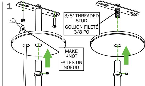
ENSURE THAT THE POWER TO THE FIXTURE'S CIRCUIT IS TURNED OFF
