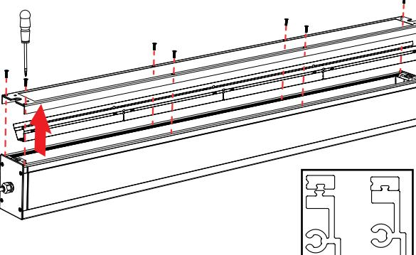
**NOTE:** BEFORE REPLACING THE TOP COVER BE SURE THAT THE GASKET IS WELL INPLACE ON THE EXTRUSION
