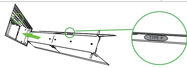
**MAKE SURE THAT THE LABELS ON THE EXTRUSION AND THE LED CARTRIDGE MATCH AND ARE BACK TO BACK ON THE SAME SIDE**
