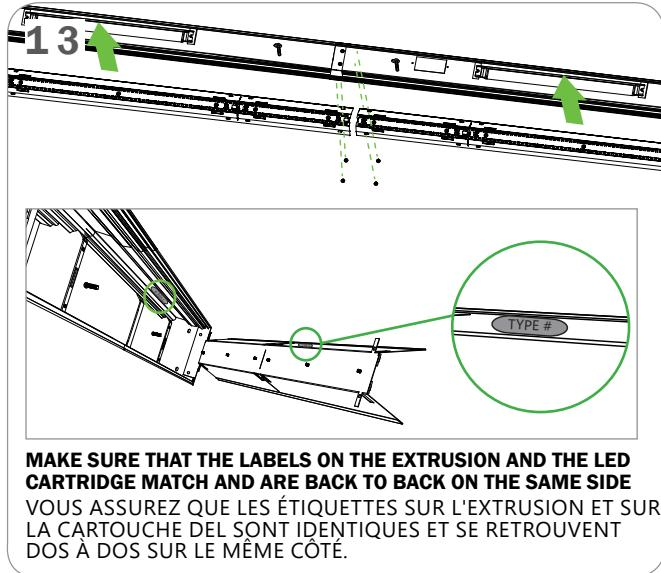
**MAKE SURE THAT THE LABELS ON THE EXTRUSION AND THE LED CARTRIDGE MATCH AND ARE BACK TO BACK ON THE SAME SIDE**
