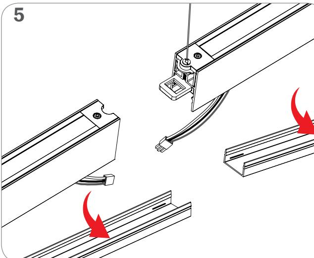
POUR ENFILADE CONTINUE SUIVRE LES ÉTAPES 1 À 3 POUR INSTALLER LE PROCHAIN LUMINAIRE AU PLAFOND PUIS:
