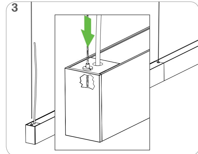
THE JUNCTION BOX MUST BE SOLIDLY FIXED AND ATTACHED TO THE STRUCTURAL MEMBER INSIDE TO THE CEILING CONNECT THE POWER CORD TO THE CEILING POWER FEED
