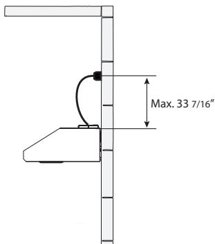
Le cordon d'alimentation doit être accessible pour l'inspection après l'installation.
