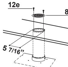
Pour la ventilation avec recyclage sans canalisation, dirigez les conduits à un emplacement au-dessus de la hotte où l'air évacué est retourné dans la pièce.
