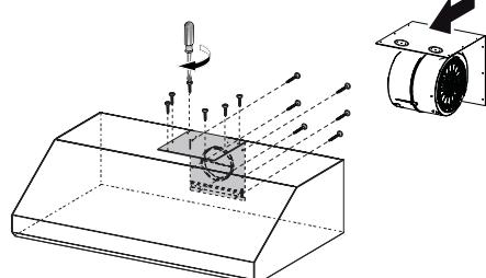
Lorsque les vis sont enlevées, dégagéz le ventilateur du bâti de la hotte et placez-le de façon à ce que l'ouverture de passage de l'air se trouve face au mur arrière (dégagéz-le de l'arrière et faites-le tourner de 180 degrés vers la gauche, puis inclinez-le de 90 degrés vers l'arrière, comme illustré dans le diagramme).
