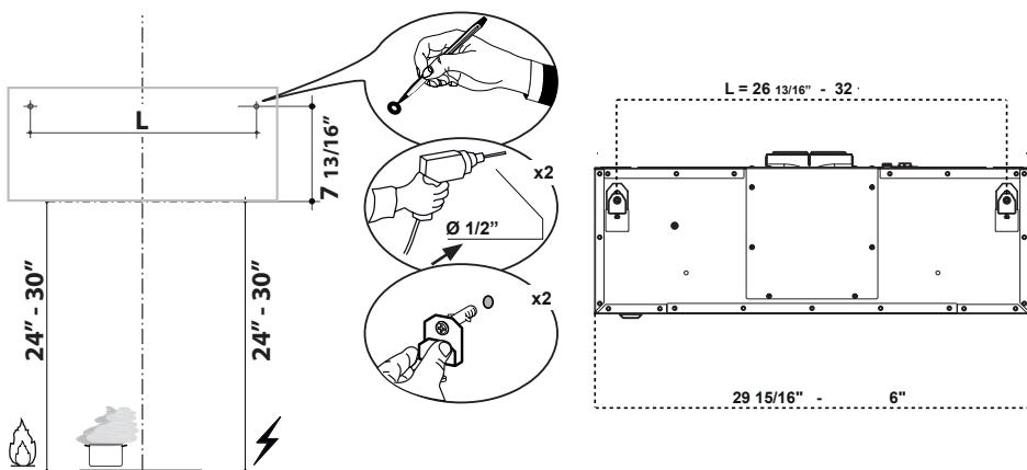
Tracez un repère sur le mur à l'endroit indiqué, **7 13/16"** au-dessus de la ligne horizontale et à la distance **L** à droite et à gauche de la ligne verticale. La distance **L** varie en fonction de la dimension de la hotte. Insérez les deux chevilles dans les orifices, comme illustré, et fixez-les.
