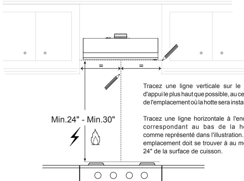
Tracez une ligne verticale sur le mur d'appui le plus haut que possible, au centre de l'emplacement où la hotte sera installée.
