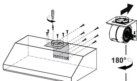
Pour l'installation d'une canalisation horizontale, le moteur doit d'abord être détaché. Pour ce faire, retirez les 12 vis comme illustré.
