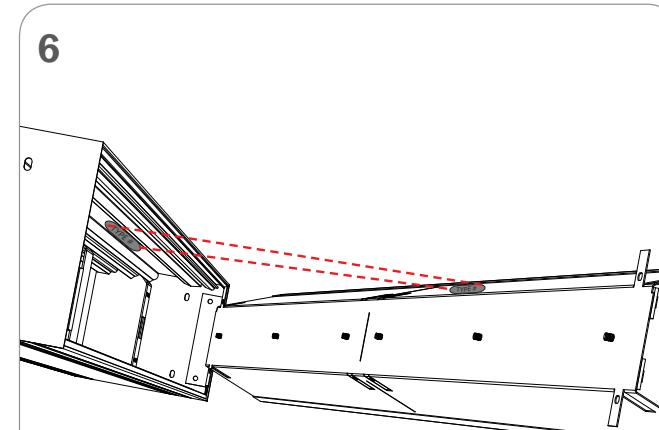
MAKE SURE THAT THE LABELS ON THE EXTRUSION AND THE LED CARTRIDGE MATCH AND ARE BACK TO BACK ON THE SAME SIDE.
