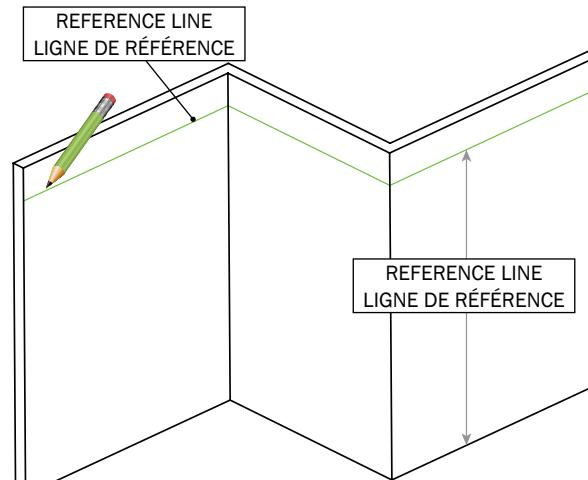
DRAW REFERENCE LINE LEVEL AROUND PERIMETER BEFORE INSTALLING WALL TRACK.
