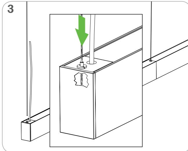
THE JUNCTION BOX MUST BE SOLIDLY FIXED AND ATTACHED TO THE STRUCTURAL MEMBER INSIDE TO THE CEILING CONNECT THE POWER CORD TO THE CEILING POWER FEED
