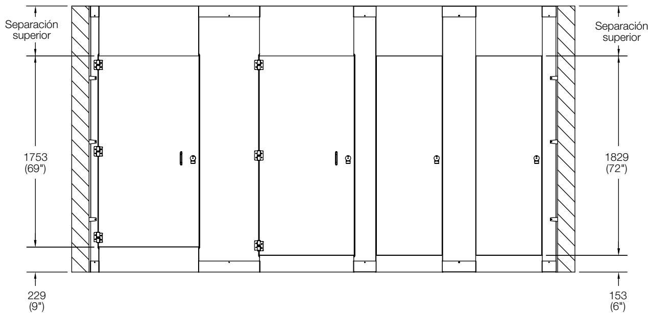
Verifique todas las dimensiones de colocación de tuberías empotradas antes de la instalación.
