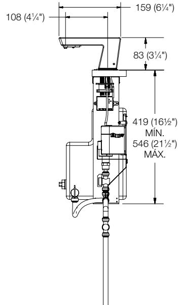
Verifique todas las dimensiones de colocación de tuberías empotradas antes de la instalación.
