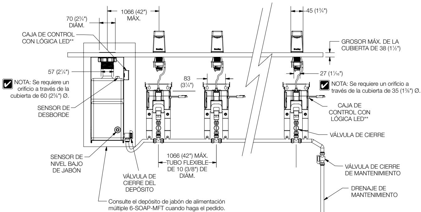
\*\* NOTA: Se requiere batería o adaptador de CA. Se requiere una fuente de energía de CA a 1371 (54") de la caja de control.
