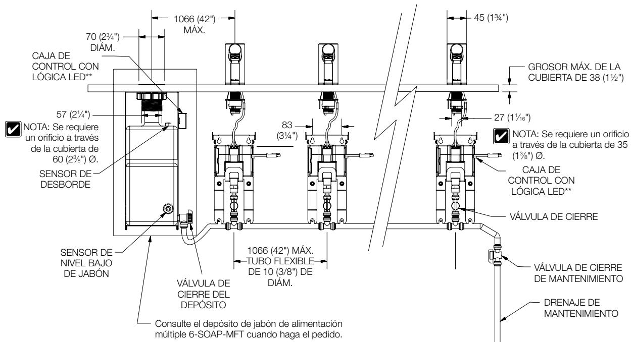
\*\* NOTA: Se requiere batería o adaptador de CA. Se requiere una fuente de energía de CA a 1371 (54") de la caja de control.
