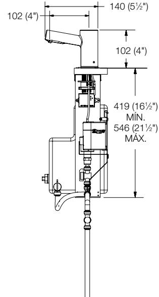
Verifique todas las dimensiones de colocación de tuberías empotradas antes de la instalación.
