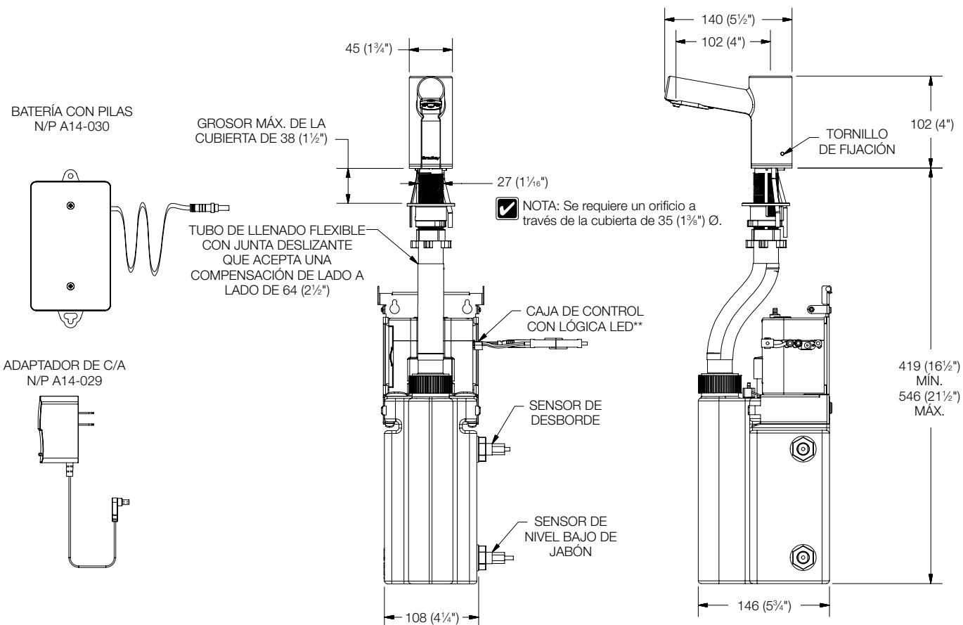
\*\* NOTA: Se requiere batería o adaptador de CA. Se requiere una fuente de energía de CA a 1371 (54") de la caja de control.
